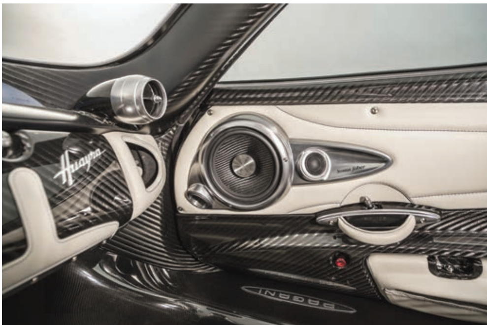
Il design è sicuramente forte, deciso, ben netto come del resto è così tutto qui dentro: in bella evidenza il pannello di supporto del sistema a due vie, realizzato al controllo numerico. In evidenza, oltre ai due altoparlanti, il condotto reflex (in basso a sinistra rispetto al woofer) che porta il suo contributo stilistico a tutto l'insieme.
