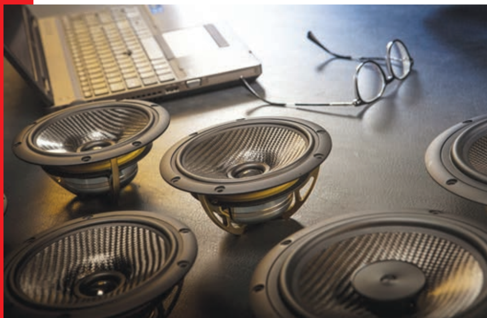
Sul tavolo del progettista gli esemplari ormai finiti e pronti per l'installazione dei coaxiali utilizzati nei canali posteriori. La struttura finale è quella con il tweeter coincidente, in modo da massimizzare spazio occupato e peso. La dimensione del midwoofer è di 130 mm, quella del tweeter di 20 mm. Tra loro un filtro passivo, l'unico di tutto il sistema che invece funziona in multi-amplificazione attiva.
