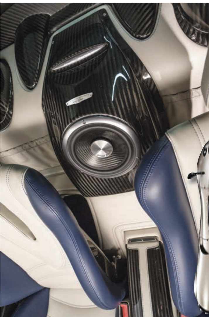
Per la gamma bassa è stato utilizzato questo woofer da 180 mm, dai parametri elettroacustici ottimizzati per lavorare nelle prime ottave della gamma audio. Il volume di lavoro di questo altoparlante è di fatto "mimetizzato" grazie al tanto carbonio a vista che distrae l'occhio e richiama le altre finiture dell'abitacolo.
