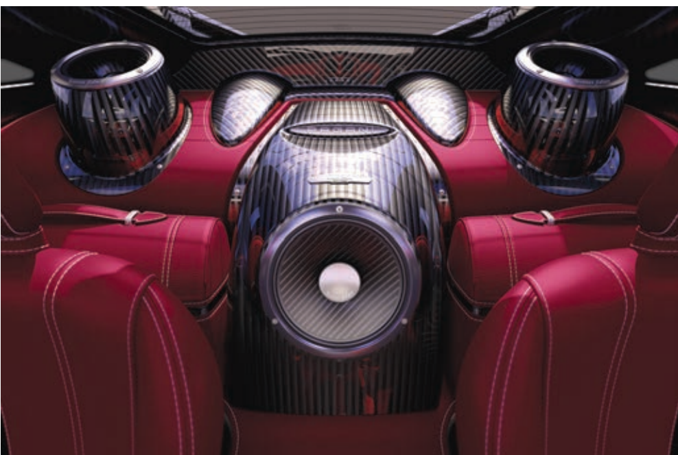
Può piacere o meno, però lo stile della Huayra non passa inosservato. Questa è la sezione "posteriore" dell'auto con i due cilindri laterali che supportano i due coassiali dedicati ai canali di ambiente e il subwoofer al centro del pannello.
